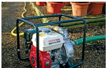
WH kan levere vandtryk op til 5 bar, hvilket gør den egnet til at transportere vand over længere afstande
