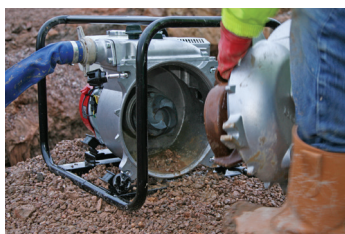
Det aftagelige inspektionsdæksel giver hurtig enkel adgang
