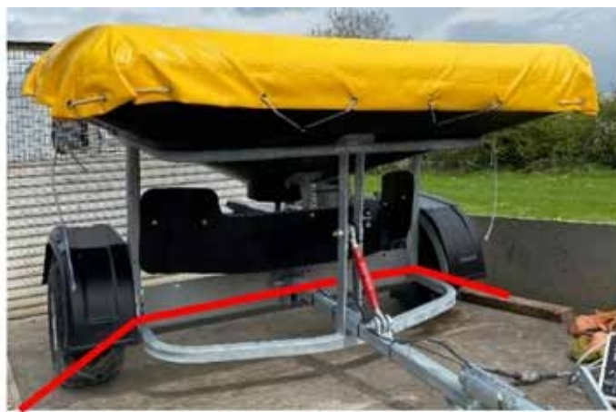
Figur 3: Översikt över bandning under transport.
