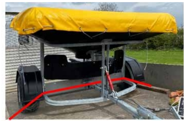
Abbildung 3: Übersicht über die Umreifung während des Transports.
