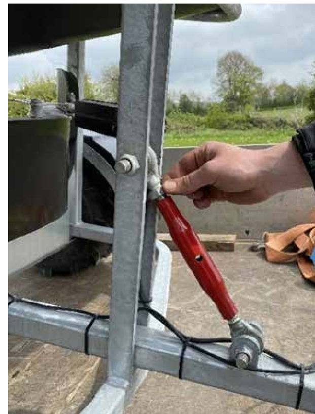
Abbildung 4: Übersicht über die Einstellung der Deichselhöhe
