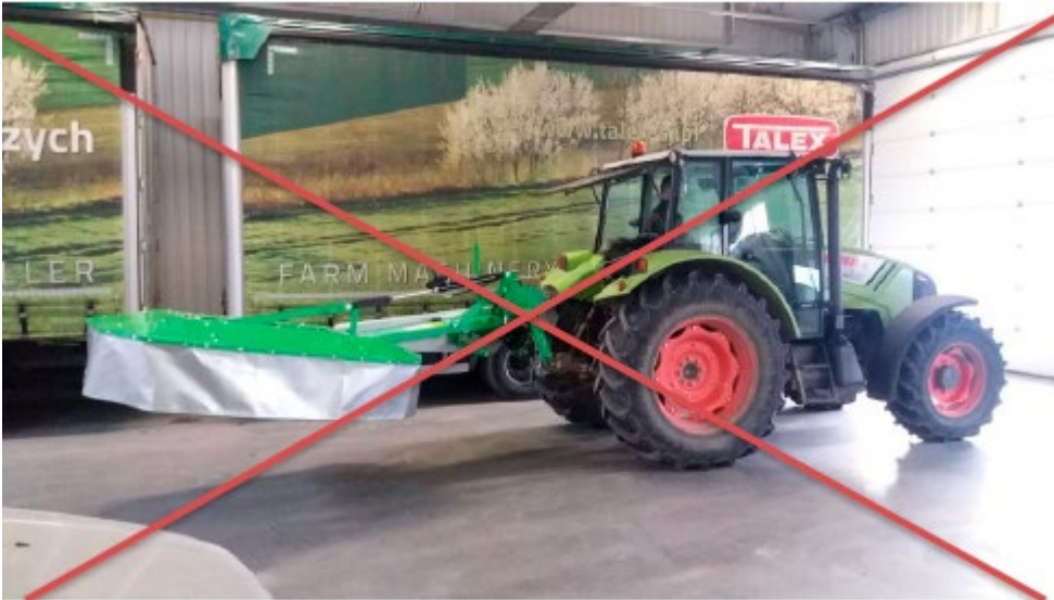
Abb. 16 – Falsche Transportstellung für Rotationsmäher mit Hydraulikzylinder.
