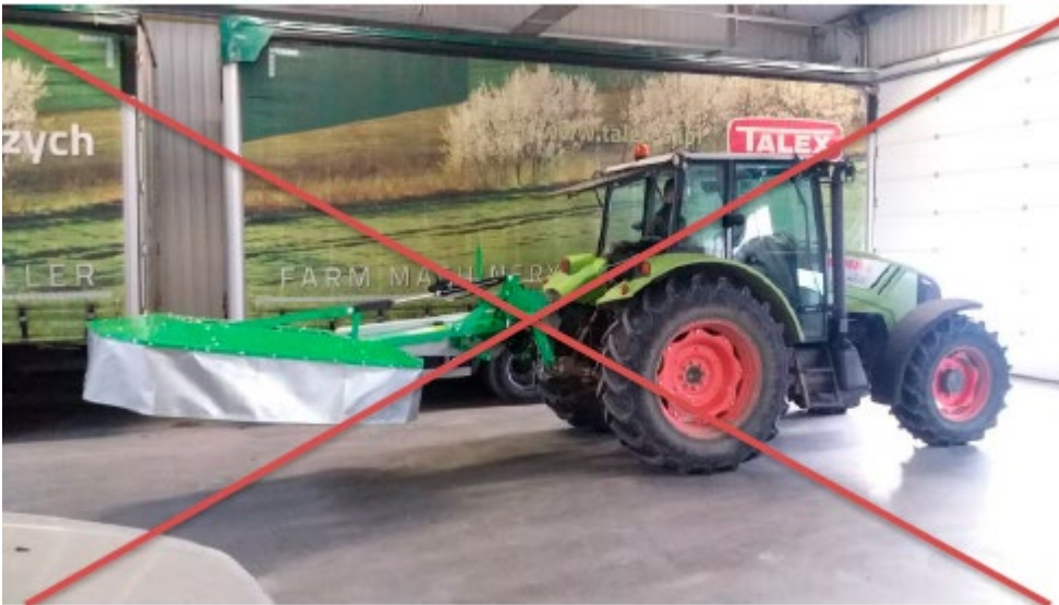
Fig. 16 - Felaktig transportläge för rotorklippare med hydraulcylinder.
