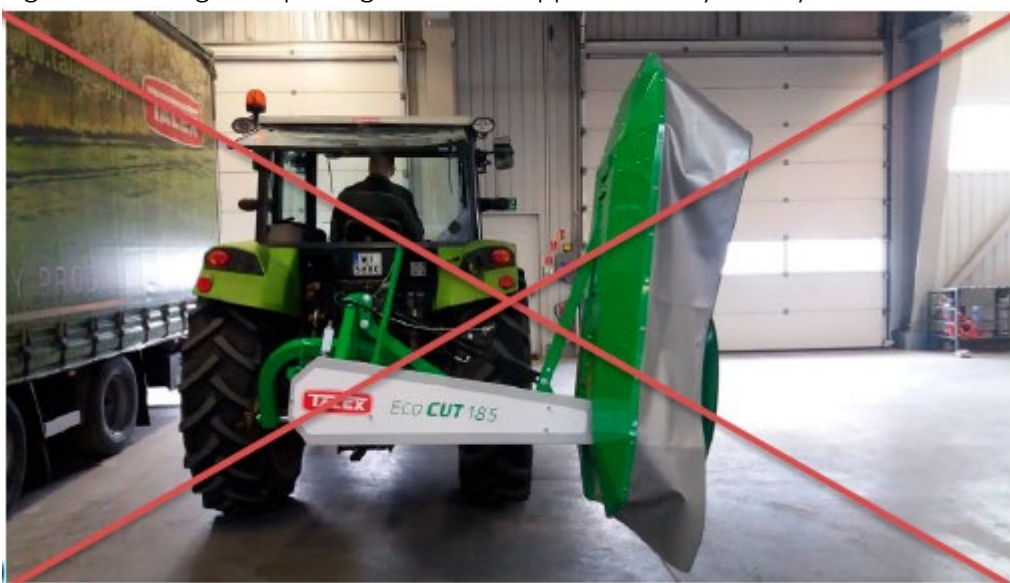
Fig. 17 - Felaktig transportläge för rotorklippare med hydraulcylinder (bredare än tillåtet).
