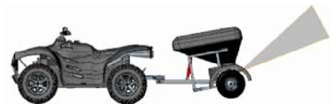
Trækstang indstillet for højt, spredningsmønsteret er opadgående.
